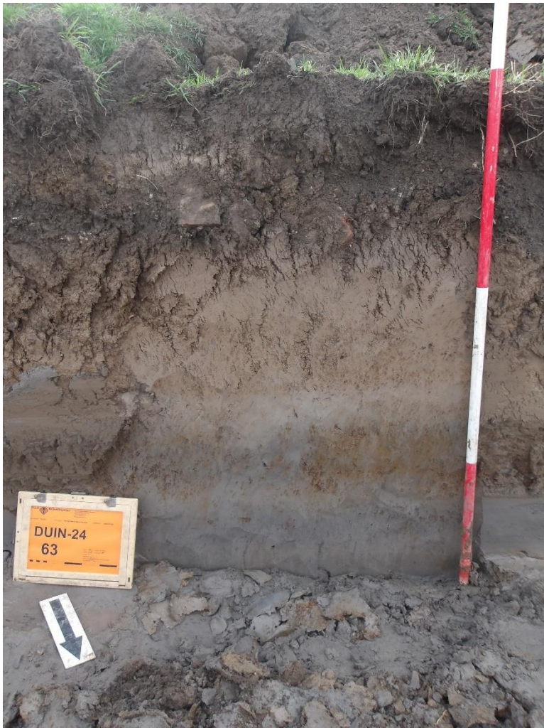
Afb. 5. Bodemopbouw in de rivierduinvlakte met bijna 1,5 m dik pakket klei bovenop het rivierduin.
