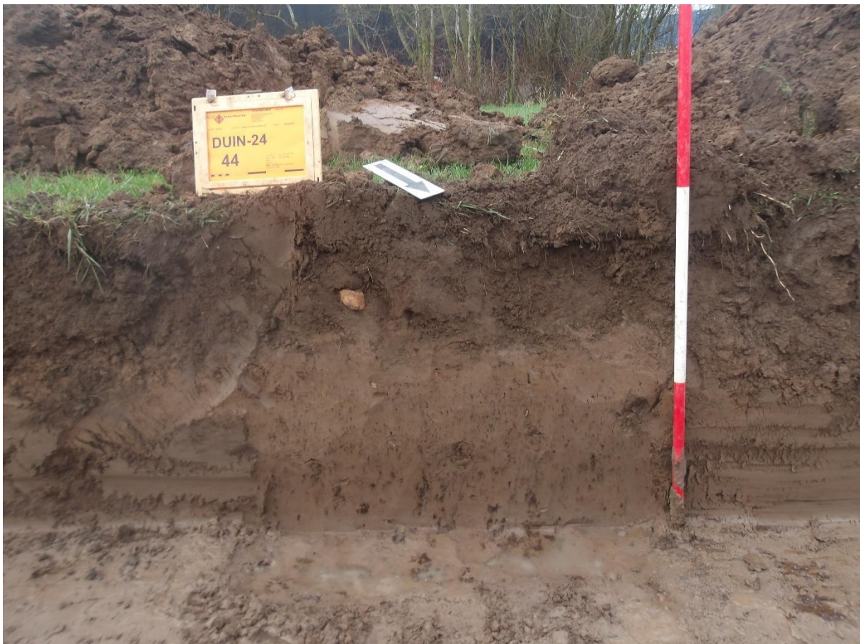
Afb. 4. 'Standaard' bodemopbouw ter hoogte van de rivierduinopduiking.
